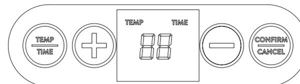
Tlačítko TEMP = stisknutím tlačítka „Temp“ vyberete jednu z teplot od 25 do 50 °C, stisknutím tlačítka „+/-“ nastavíte teplotu s přírůstkem po 1 stupni.
