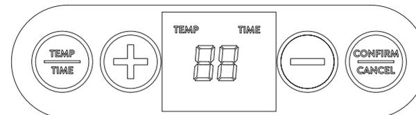
TEMP-Taste = Drücken Sie die „Temp“-Taste, um eine Temperatur zwischen 25 °C und 50 °C auszuwählen. Drücken Sie die „+/-“-Taste, um die Temperatur um 1 Grad zu verändern.
