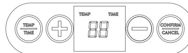
TEMP-knop = Druk op de knop "Temp" om een van de temperaturen van 25°C tot 50°C te selecteren, druk op de knop "+/-" om de temperatuur in stappen van 1 graad aan te passen.
