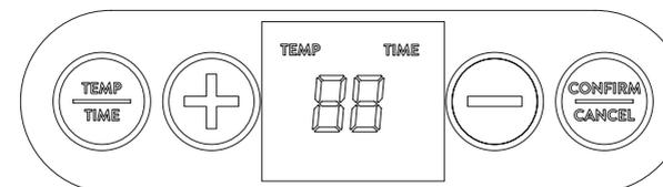
Pulsante TEMP = Premi il pulsante "Temp" per selezionare una delle temperature da 25°C a 50°C, premi il pulsante "+/-" per regolare la temperatura con incrementi di 1 grado.
